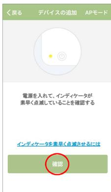
3. リセットボタンの周囲のインディケータが素早く点滅していることを確認してから「確認」をタップしてください。
